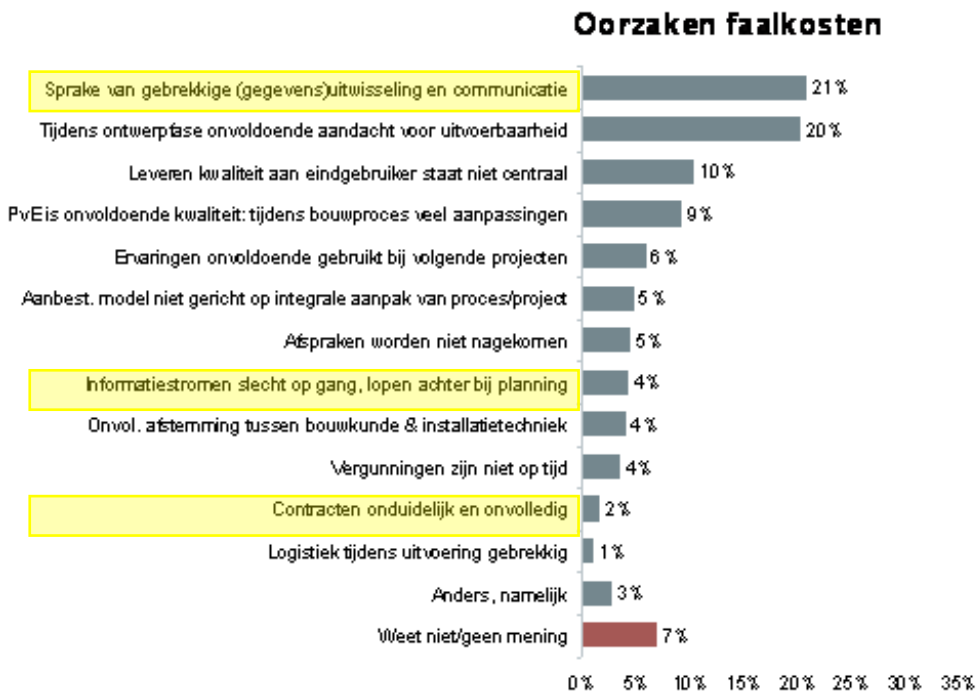
Figuur 1. Oorzaken van faalkosten (bron: USP Consultants)
