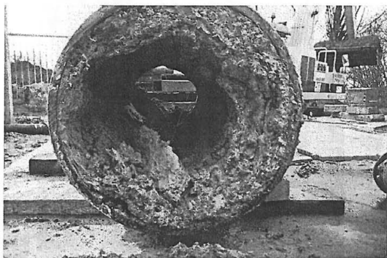
Figuur 4.2 Scaling van \text{Al(OH)}_3 in een ronde 600 mm AC-buis (Bron: Deltares)
